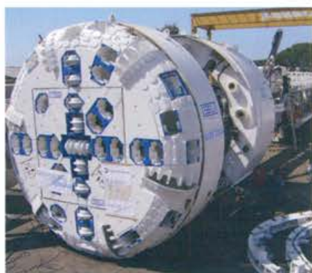
Tuneladora del Metro de Nueva York
